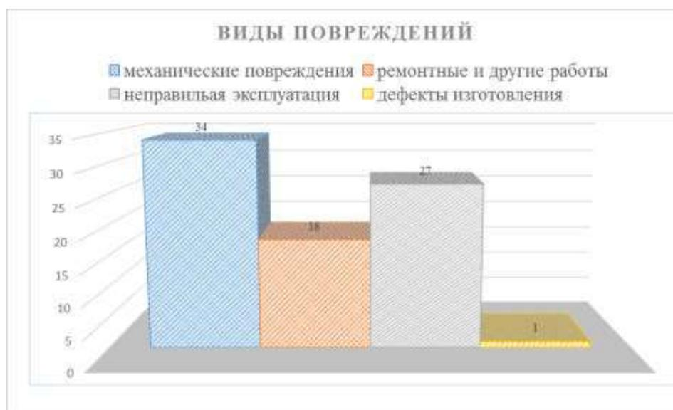
Рис. 1. Распределение аварий на нефтегазовом оборудовании по видам инициирующих повреждений.
