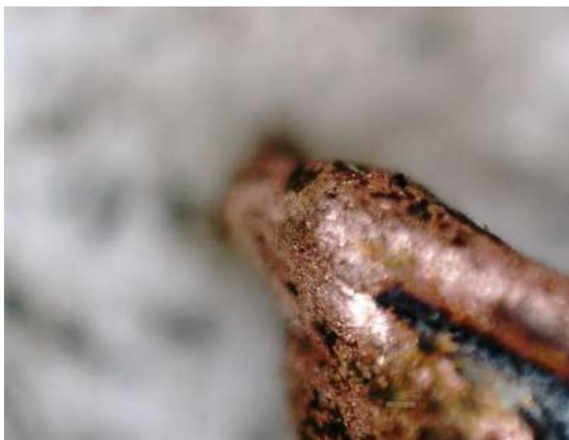
Рис. 13. Гладкая поверхность оплавления в виде косого среза на конце жилы фрагмента медного провода № 2 при увеличении  $\times 400$
