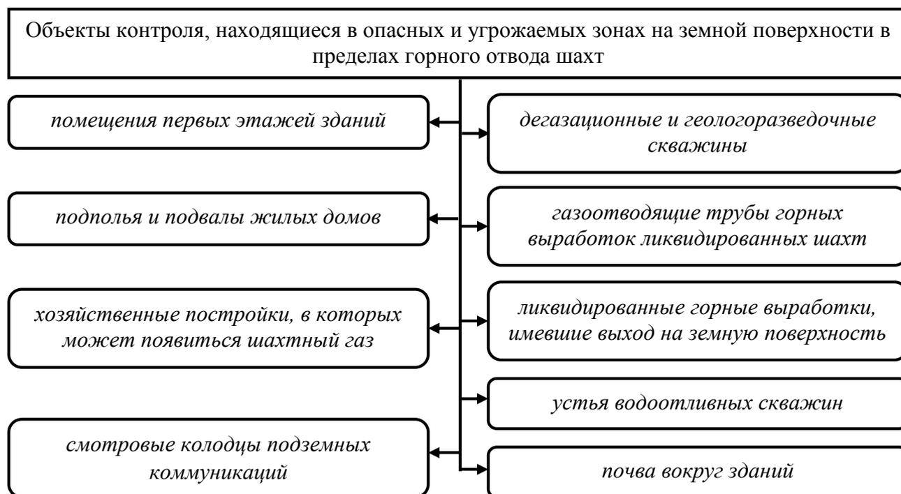
Рис. 5. Объекты контроля, находящиеся в опасных и угрожаемых зонах на земной поверхности в пределах горного отвода шахт
