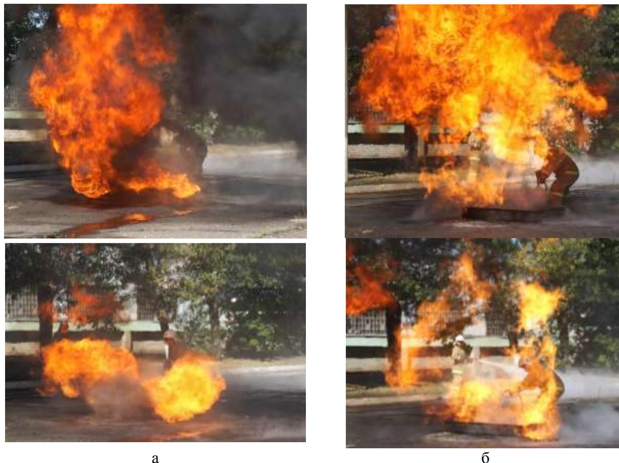
Рис. 1. Процесс тушения модельного очага 55В струями ТАВ с концентрацией ингибирующей соли:
