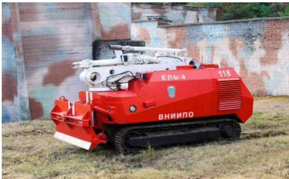
Рис.2. Роботизированный комплекс «Ель-4»
