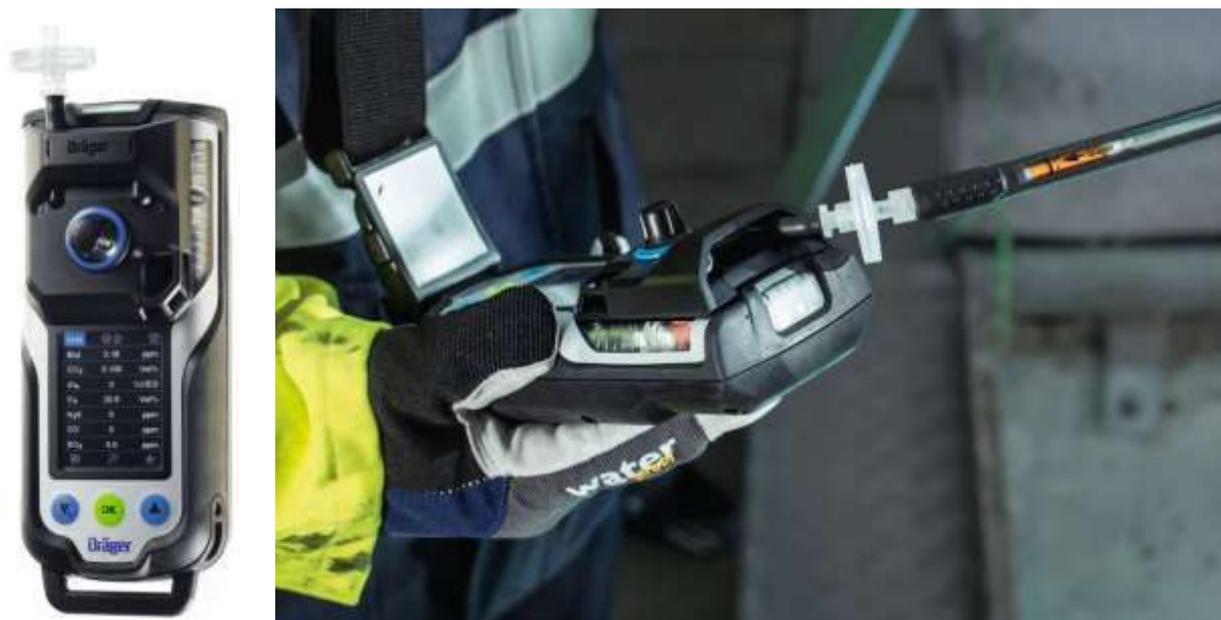
Рис. 5. Многоканальный газоанализатор Dräger X-am 8000
