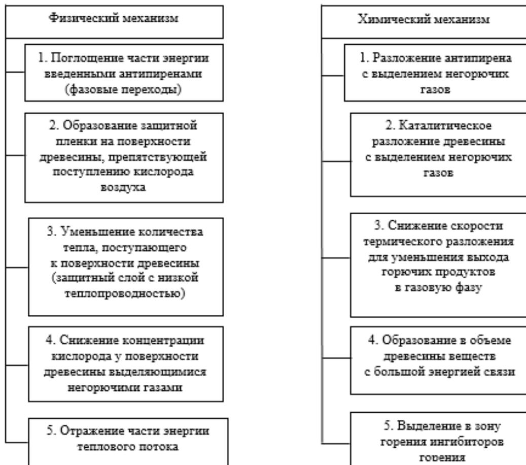
Рис. 1. Основные механизмы огнезащитного действия покрытий для древесины
