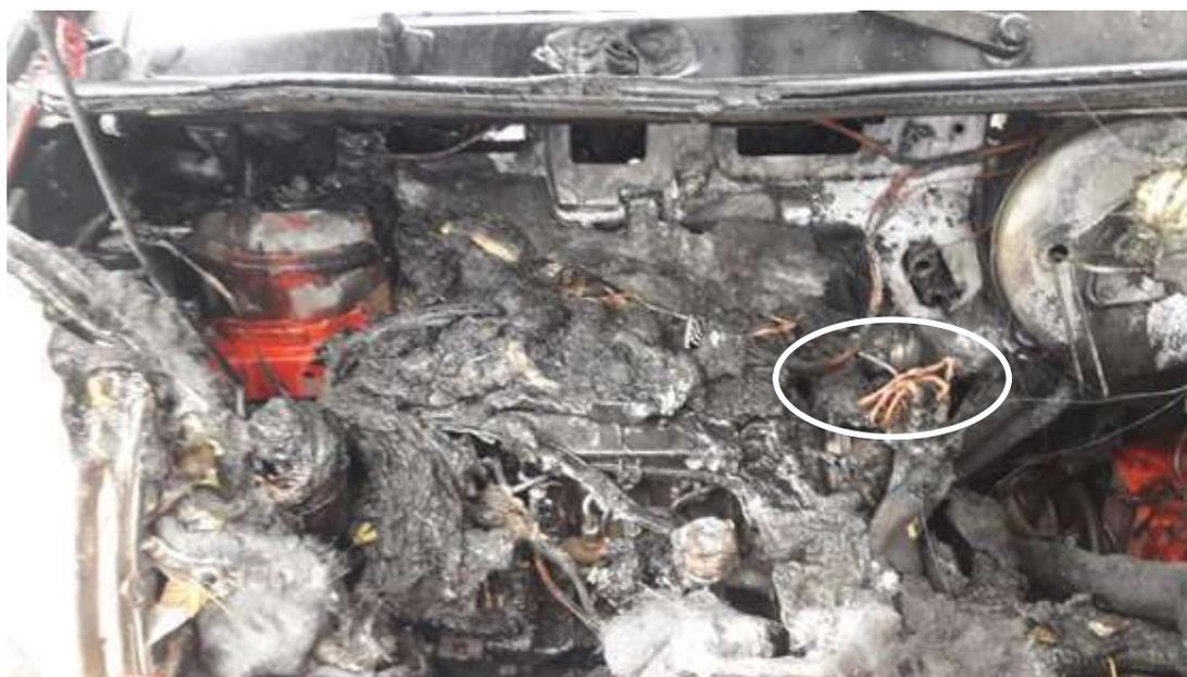
Рис. 7. Расположение электрических медных проводов, подсоединенных к уничтоженному пожаром генератору
