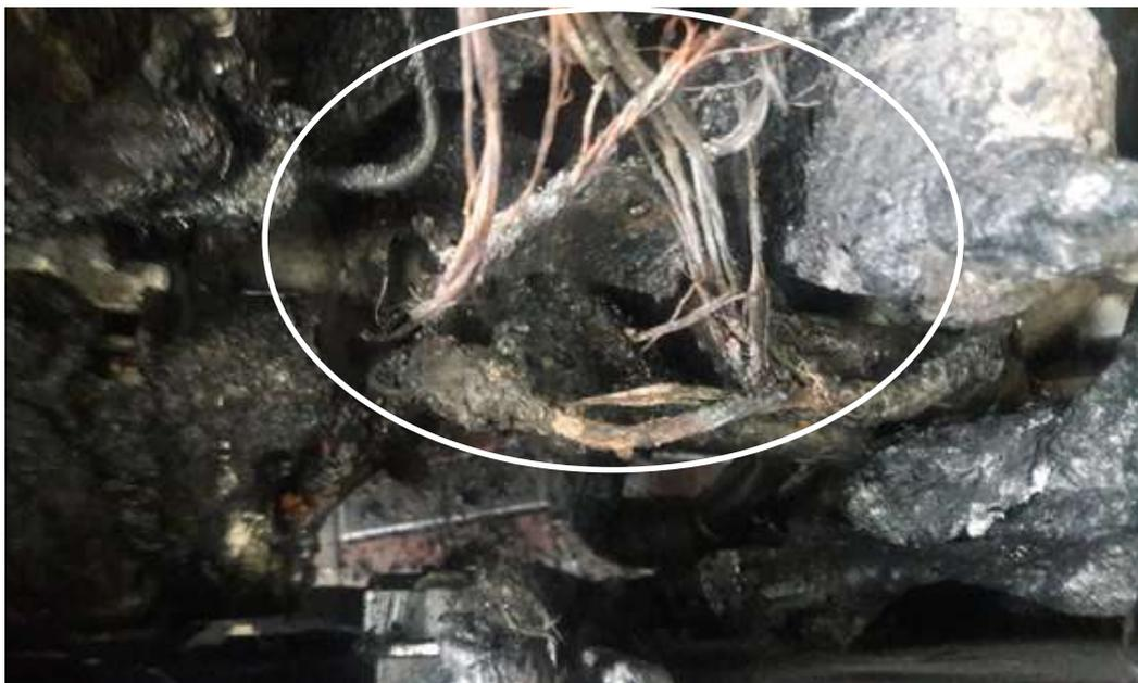
Рис. 8. Электрические медные провода в моторном отсеке, подсоединенные к уничтоженному пожаром генератору, со следами «спекания» и шарообразных оплавлений на оконцеваниях
