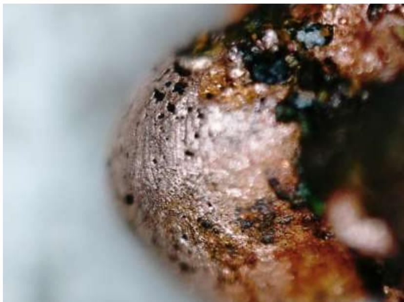
Рис. 12. Гладкая поверхность шарообразного оплавления на конце жилы фрагмента медного провода образца № 3 при увеличении  $\times 400$
