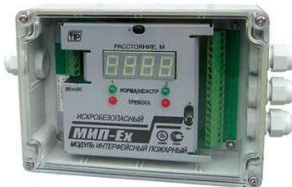
Рис. 3. Внешний вид модуля МИП-2И-Ех
