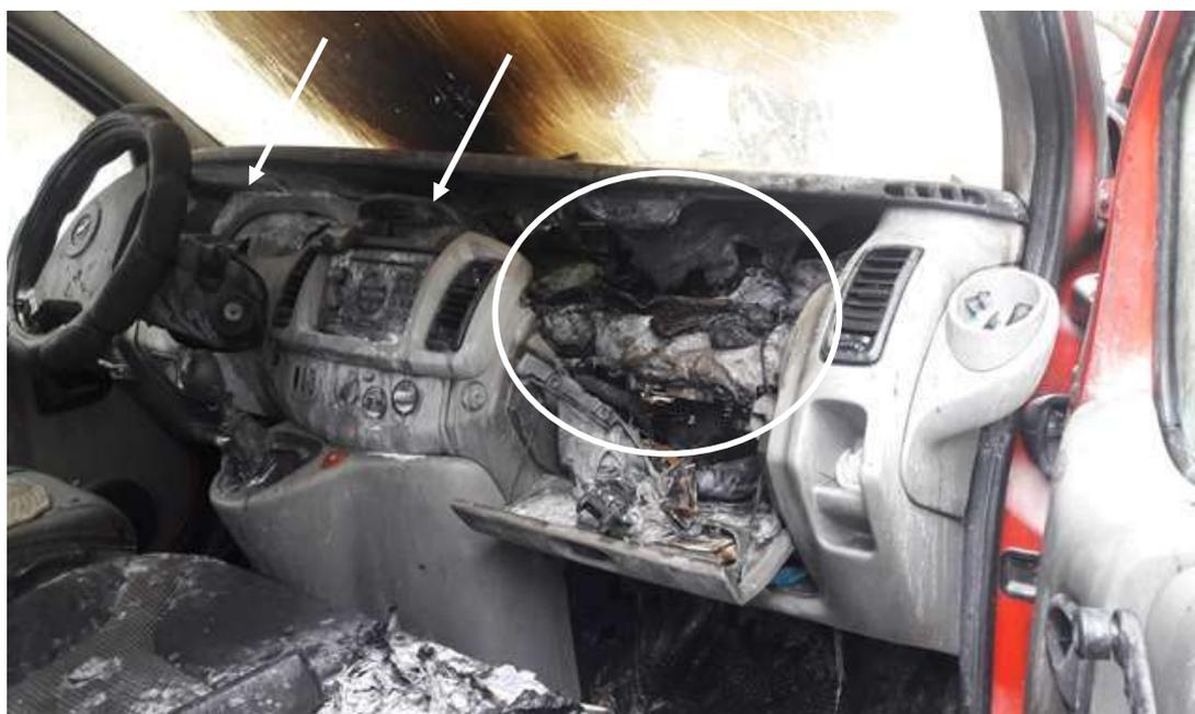
Рис. 5. Сквозное проплавление приборной панели в месте расположения полочки, подушки безопасности переднего пассажира, перчаточного ящика и пластиковых элементов в районе рулевого колеса
