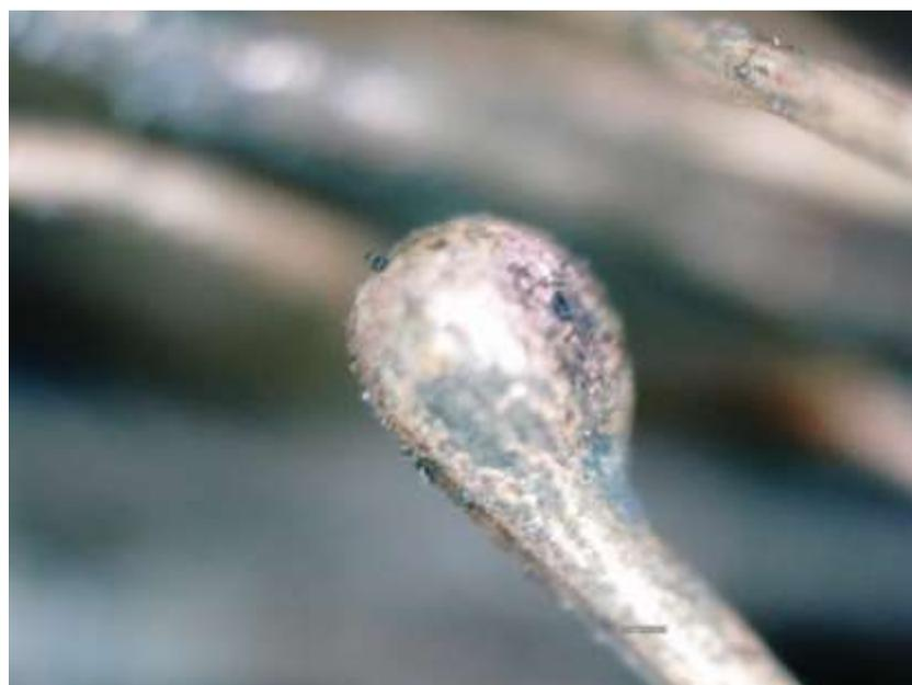
Рис. 11. Гладкая поверхность шарообразного оплавления на поверхности жилы фрагмента медного провода образца № 1 при увеличении x400
