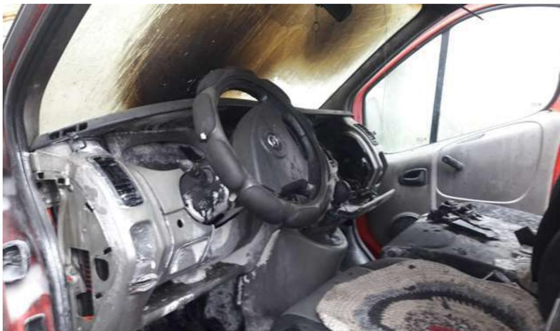
Рис. 4. Закопчение лобового стекла со стороны моторного отсека
