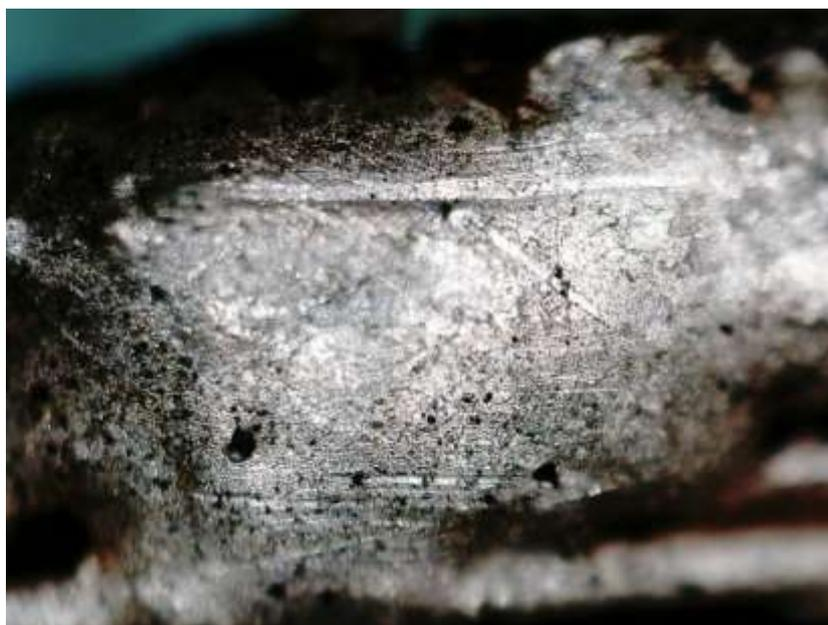
Рис. 10. Гладкая поверхность локального оплавления на поверхности жилы фрагмента медного провода образца № 1 при увеличении x400
