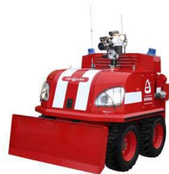
Рис. 1. Пожарная установка “Пеликан”
