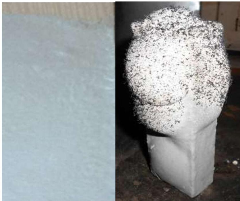
а) до термического воздействия; б) после термического воздействия
