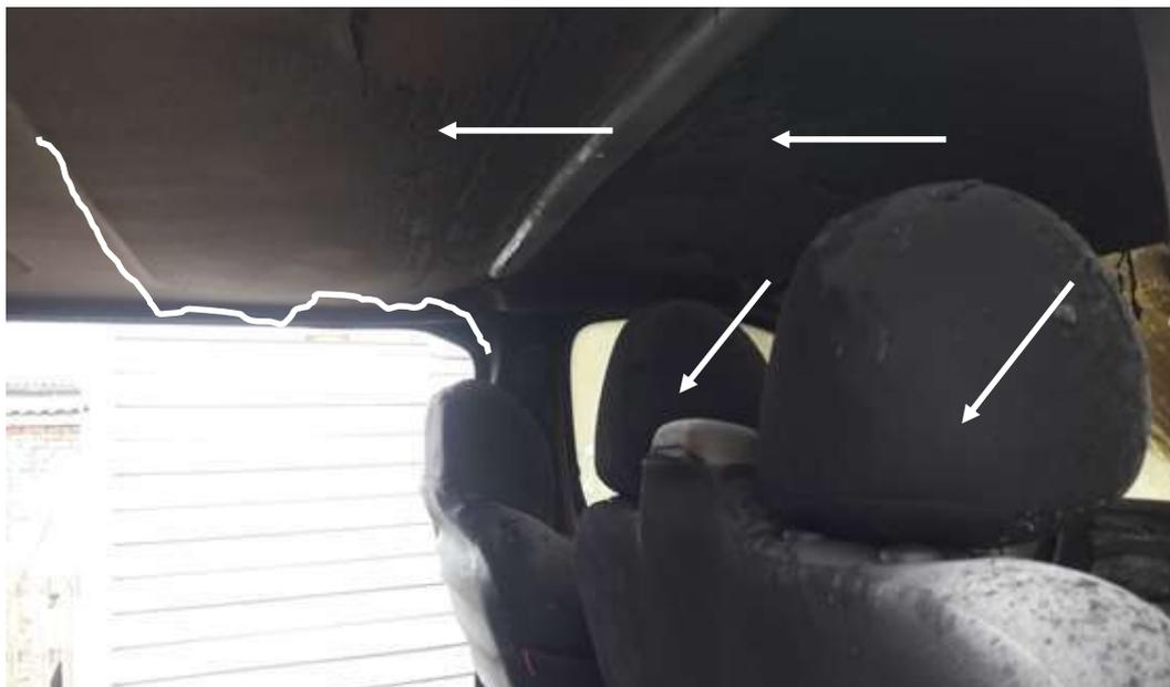
Рис. 6. Потолок салона и передних сидений со следами копоти (сплошной линией обозначена граница копоти на потолке, стрелками обозначена копоть на поверхности предметов)
